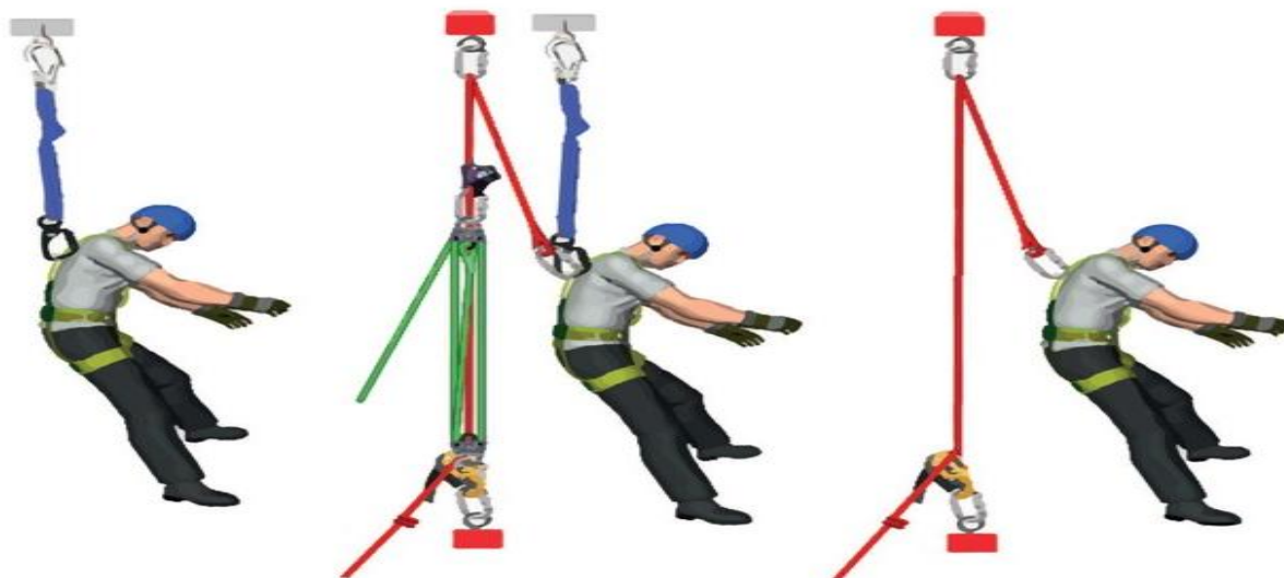
Изображение 8 -Система спасения и эвакуации в случае возникновения аварийной ситуации или несчастного случая при работе на высоте
